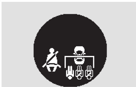
На рисунке показан случай, когда используются ремни безопасности правого и центрального сиденья.
