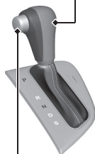
Кнопка освобождения рычага от фиксации
