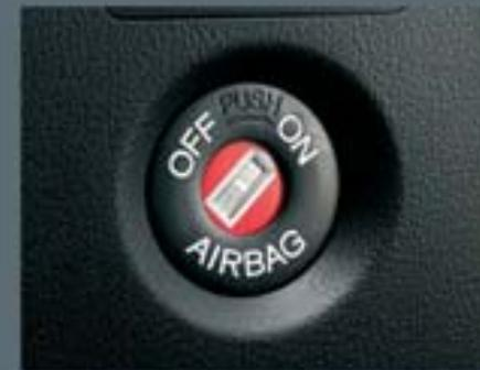
Переднее пассажирское сиденье оснащено креплением ISO-FIX. Для обеспечения безопасности ребенка можно отключить подушку безопасности переднего пассажира. Отключение/включение производится поворотом ключа зажигания в положение ON или OFF.
